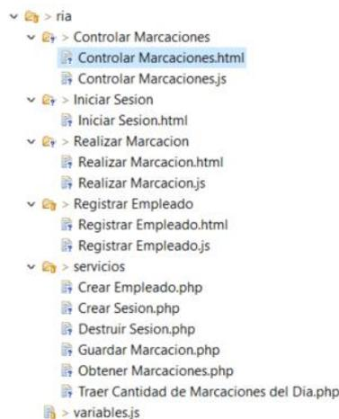
Figura 4.5: Estructura de archivos para el sistema de marcación de empleados.
