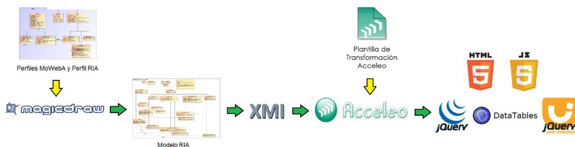
Figura 4.1: Proceso de modelado y generación de RIA.
