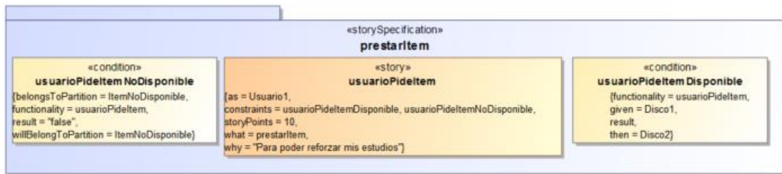
Figura 13: Modelado de historia de usuario “As Usuario1 , I want prestarItem , so that Para poder reforzar mis estudios ” con dos pre y post condiciones.
