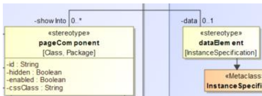
Figura 10: Relación entre un <<pageComponent>> y un <<dataElement>>
